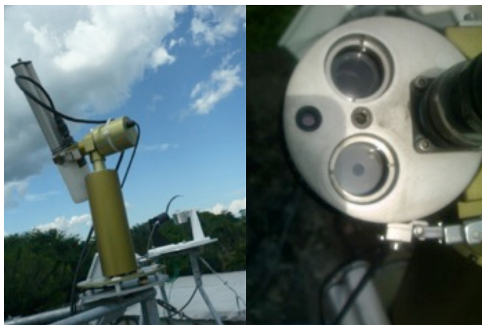
Figura 6 - Fotômetro solar da rede AERONET instalado na Embrapa. A direita aparecem as janelas de quartzo que ficam entre a cabeça óptica e os colimadores.
